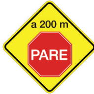
Proximidad de Señal Restrictiva
