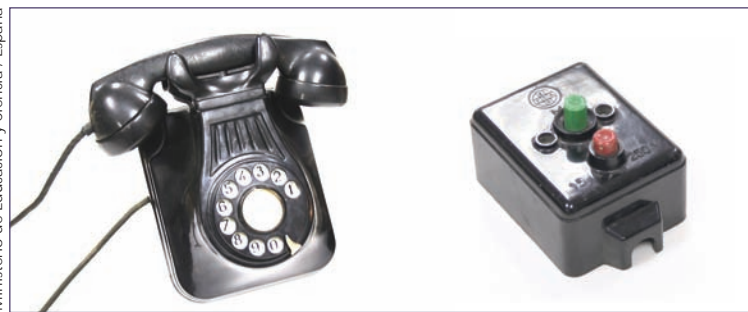
Baquelita, un material utilizado para confeccionar los antiguos teléfonos analógicos y los modernos interruptores trifásicos.
